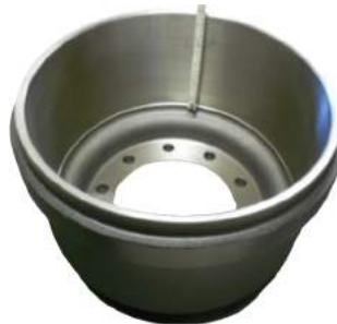
2. Ancho de la superficie de frenado
