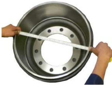
1. Diámetro de la superficie de frenado
